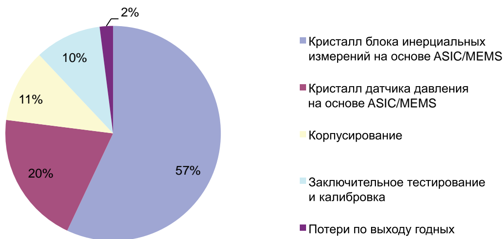
Рисунок 2. Структура издержек производства семиосевого комбинированного датчика ICM-20789 производства InvenSense/TDK
