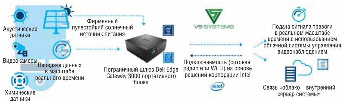
Рисунок 3. Структура портативного блока безопасности корпорации V5 Systems
