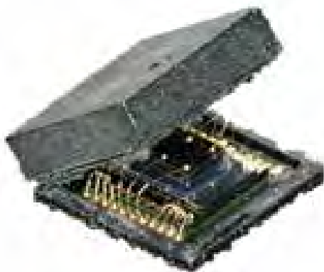
Вскрытие корпуса – удаление верхней части корпуса
